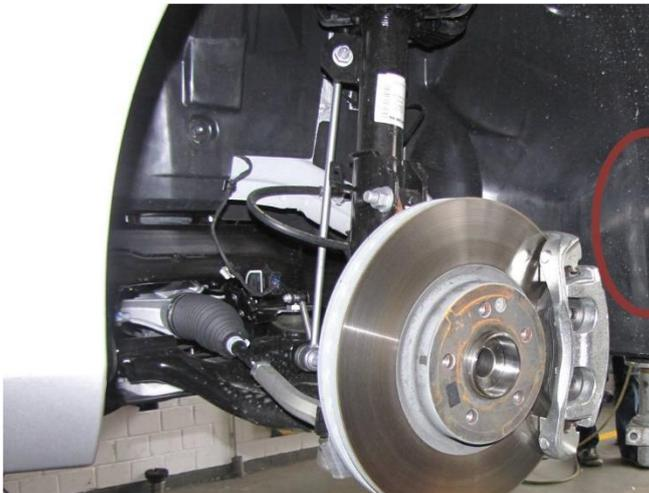
L01) Der Lenkeinschlag ist durch Unterlegen des Anschlags mit einer Unterlegscheibe von ?mm Dicke zu begrenzen.
