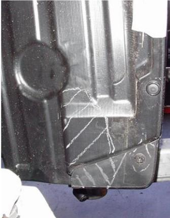
K88) Um eine ausreichende Freigängigkeit der Rad-Reifen-Kombination an Achse 1 zu gewährleisten sind folgende Maßnahmen erforderlich:
