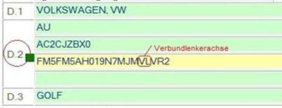
E91) Nur zulässig an Fahrzeugausführungen mit Mehrlenkerachse. In der Zulassungsbescheinigung I, Feld D.2, im Versionenschlüssel steht 'ML':
