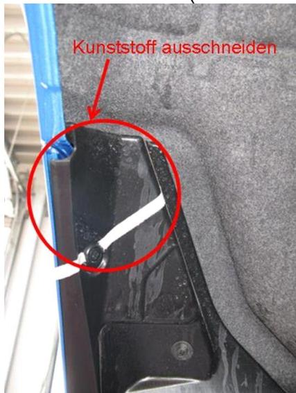
K59) An Achse 1 ist die Ausbuchtung des Kunststoffinnenkotflügels im Bereich der Stoßfängeroberkante auszuschneiden und die dahinterliegende Stoßfängerbefestigungslasche um 5 mm zu kürzen.
