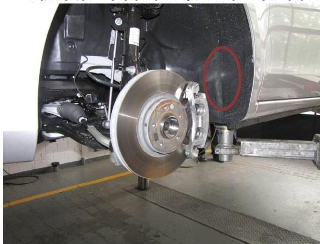
K132) Um eine ausreichende Freigängigkeit an Achse 2 herzustellen ist der Kunststoffflap der Radhauskante im Bereich der Oberkante Stoßfänger bis 50 Grad hinter der Radmitte innen um 5 mm zu kürzen.
