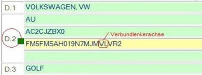
E91) Nur zulässig an Fahrzeugausführungen mit Mehrlenkerachse. In der Zulassungsbescheinigung I, Feld D.2, im Versionenschlüssel steht 'ML':
