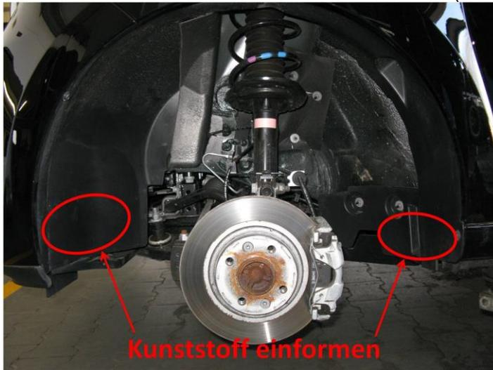
K99) An Achse 1 ist die ins Radhaus ragende Kante der Kunststoffradhausverbreiterung komplett zu kürzen.
