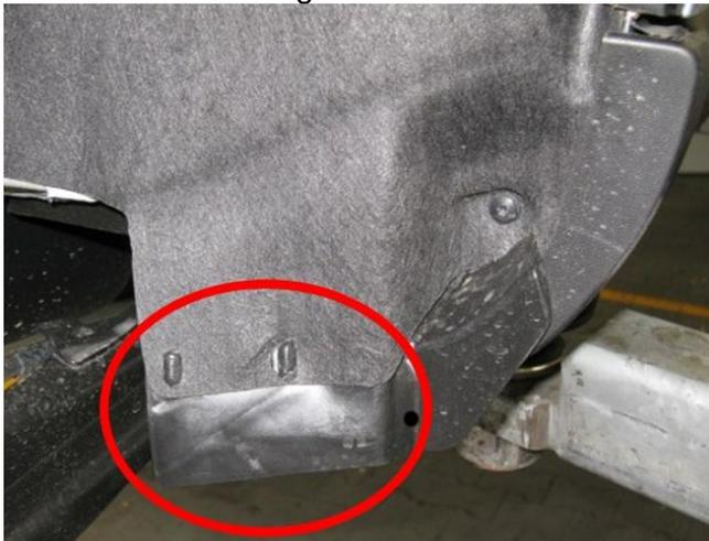
K51) Um eine ausreichende Freigängigkeit der Rad-Reifen-Kombination an Achse 2 zu gewährleisten sind folgende Maßnahmen erforderlich:
