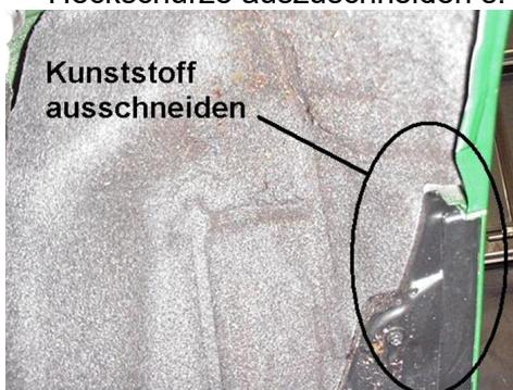
K69) Um eine ausreichende Freigängigkeit der Rad-Reifen-Kombination an Achse 1 zu gewährleisten sind folgende Maßnahmen erforderlich:
